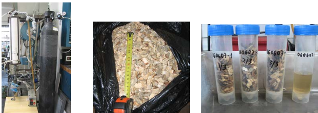
Figura 6. Imatges de la pre-piròlisi de biomassa a l'Institut de Carboquímica (d'esquerra a dreta): Reactor; Biomassa abans de l'assecatge; Biomassa assecada i aigua condensada procedent de l'assecatge.
